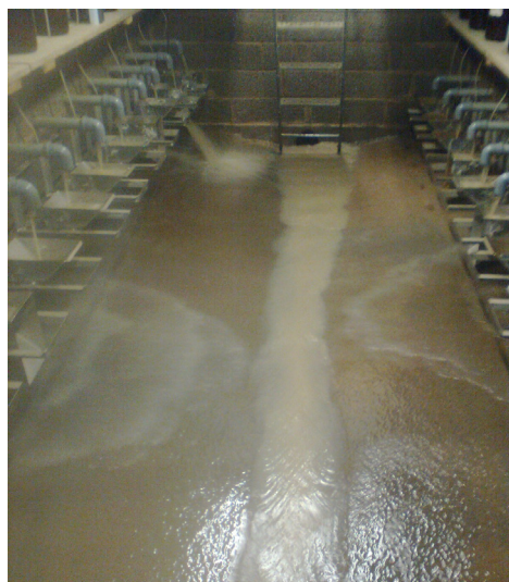
Bild 1. Vippkärl med flödesregistrering och flödesproportionell provtagning i en bunker under försöksrutorna vid Oxelby. Foto Johan Frank.
