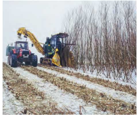
Salix som energigröda skördas på vintern. Här en australiensisk sockerrörskördare på Svalövsgården. Foto Roland Lyhagen.
