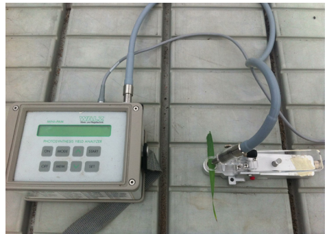
Bild 3. Mini-PAM för att mäta klorofyllfluorescens. (A Mini-PAM used for measuring chlorophyll fluorescence)
